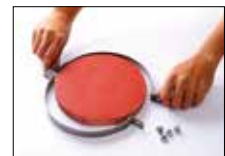
硬化後、型枠を取り外す
