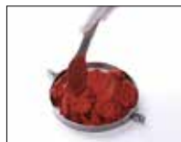
テクノカラーを型枠に入れる
